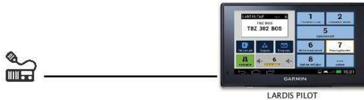
Hierbei ist das Funkgerät über ein Kabel (oder Bluetooth) direkt mit dem LARDIS PILOT verbunden. Die Konfiguration des Systems erfolgt mittels des Programms **LARDIS ONE Setup**.
