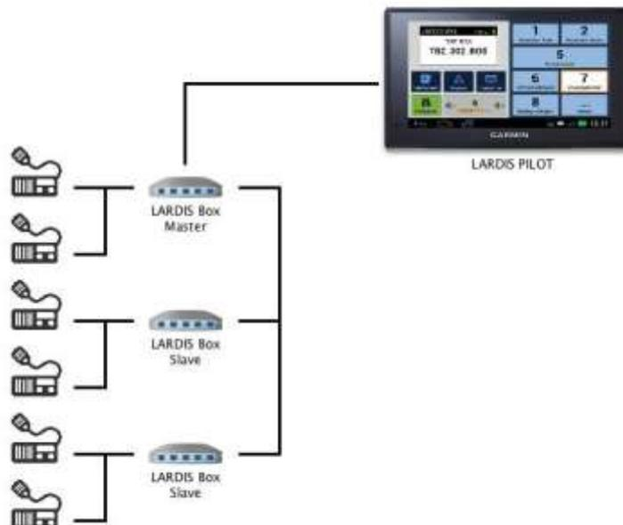
Hierbei ist das LARDIS PILOT über ein serielles Kabel mit der Com3-Schnittstelle einer LARDIS Box verbunden (Master oder Slave Box). Die Konfiguration des Systems ist in der LARDIS Master Box des Systems gespeichert und erfolgt mittels des Programms **LARDIS Tools**.
