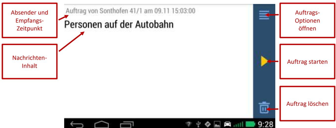
Über das gelbe Pfeil-Symbol auf der rechten Seite kann der Auftrag gestartet werden. Dies startet automatisch die Zielführung mit den im Auftrag enthaltenen Navigationsdaten und wechselt zur Navigationsansicht.
